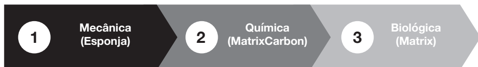
Figura 5: Camadas das mídias filtrantes (de baixo para cima)
